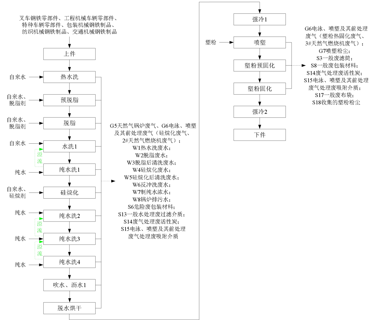
图 3-6 单纯喷塑及其前道表面处理生产工艺流程及产污环节示意图（噪声伴随整个生产过程）
